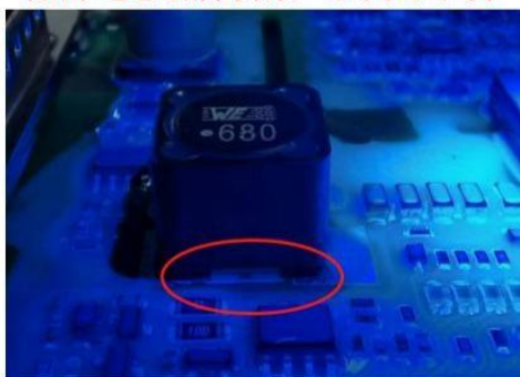
贴片电感引脚喷涂，表面可不喷
