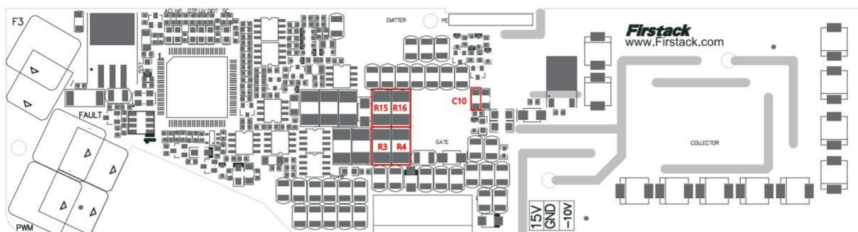
图 14 门极电阻位置指示图
