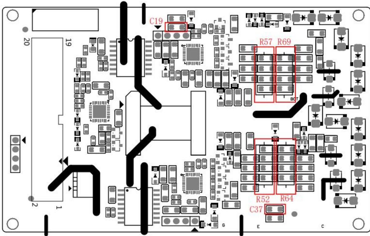
图 3 门极电阻电容位置指示图
